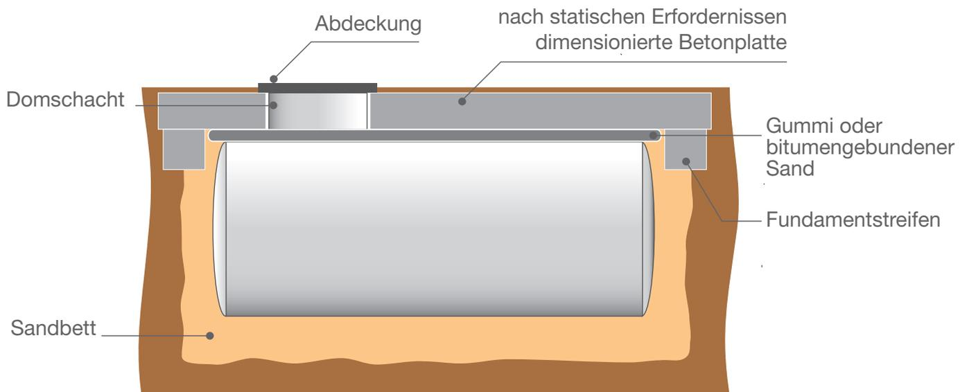
Auftriebssicherung Erdtank mit Betonplatte
