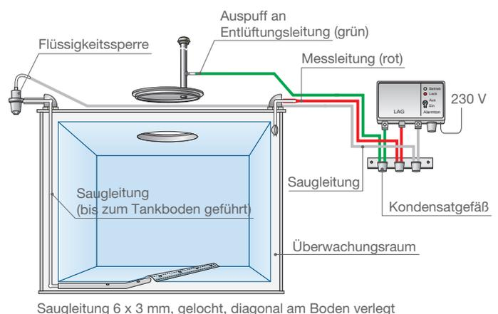
Leckschutzauskleidung mit Leckanzeigegerät
