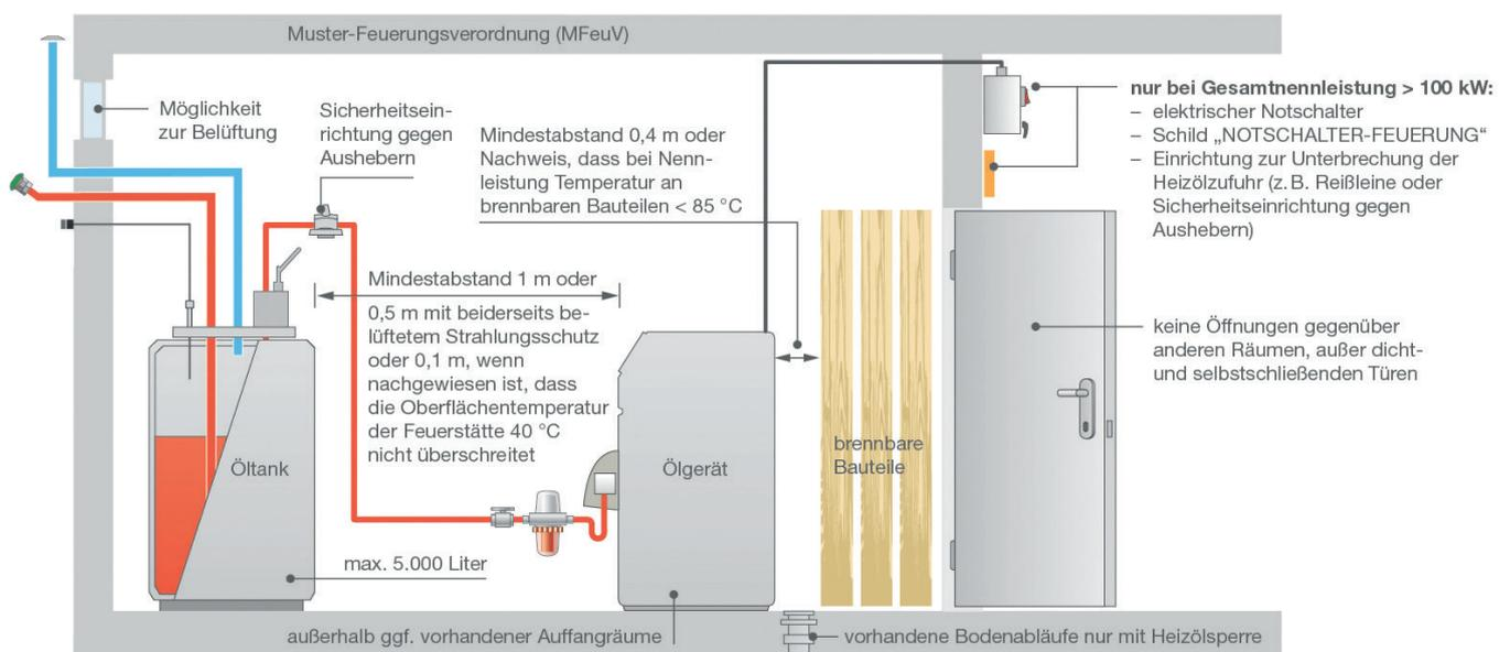
Befinden sich Feuerstätte und Lagerung von > 1.000 l, jedoch ≤ 5.000 l Heizöl in einem Raum oder handelt es sich um eine Feuerstätte > 100 kW, darf der Aufstellraum nicht anderweitig genutzt werden, ausgenommen zur Aufstellung von Wärmepumpen, Blockheizkraftwerken und ortsfesten Verbrennungsmotoren sowie zur Lagerung von Brennstoffen.
