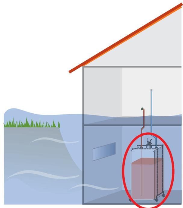
Variante 2: Tankanlage durch Verankerung sichern
